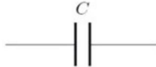
Come abbiamo visto, l'unità di misura utilizzata per i condensatori è il **farad**, ma poiché non esiste un condensatore con una tale capacità, si utilizzano i suoi sottomultipli.
